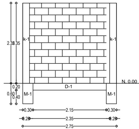
BARDA DE BLOCK MACIZO DE 12X20X40 CM ASENTADO CON MORTERO DE JUNTEO Y REFUERZOS DE CASTILLOS A DISTANCIA INDICADA ACABADO INICIAL REPELLADO FINO Y ACABADO FINAL PINTURA VINILICA .
